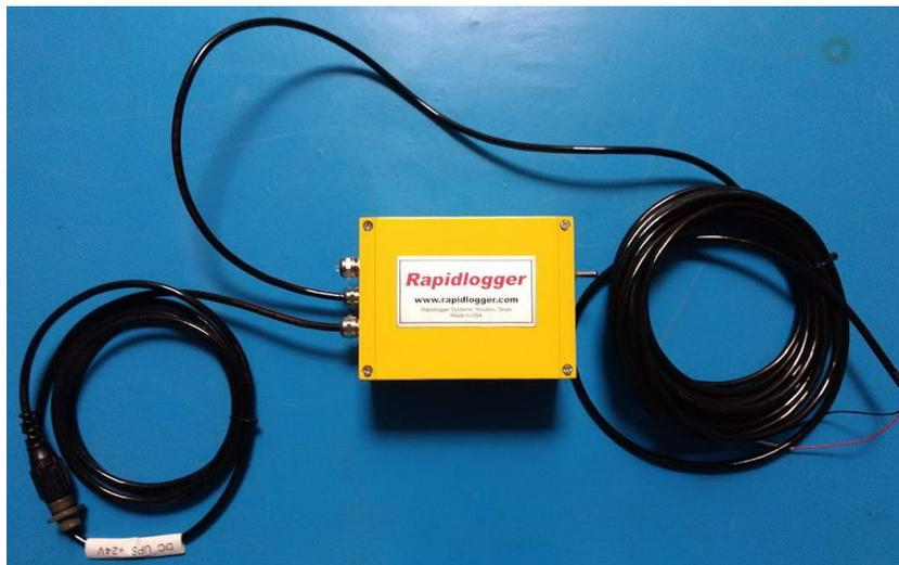
La fuente de alimentación DC-UPS del sistema Rapidlogger acepta entrada de alimentación de 9 a 36 voltios DC. Esto hace que sea posible conectarlo directamente a los sistemas eléctricos de camiones tipo batería de 12 y 24 voltios.
