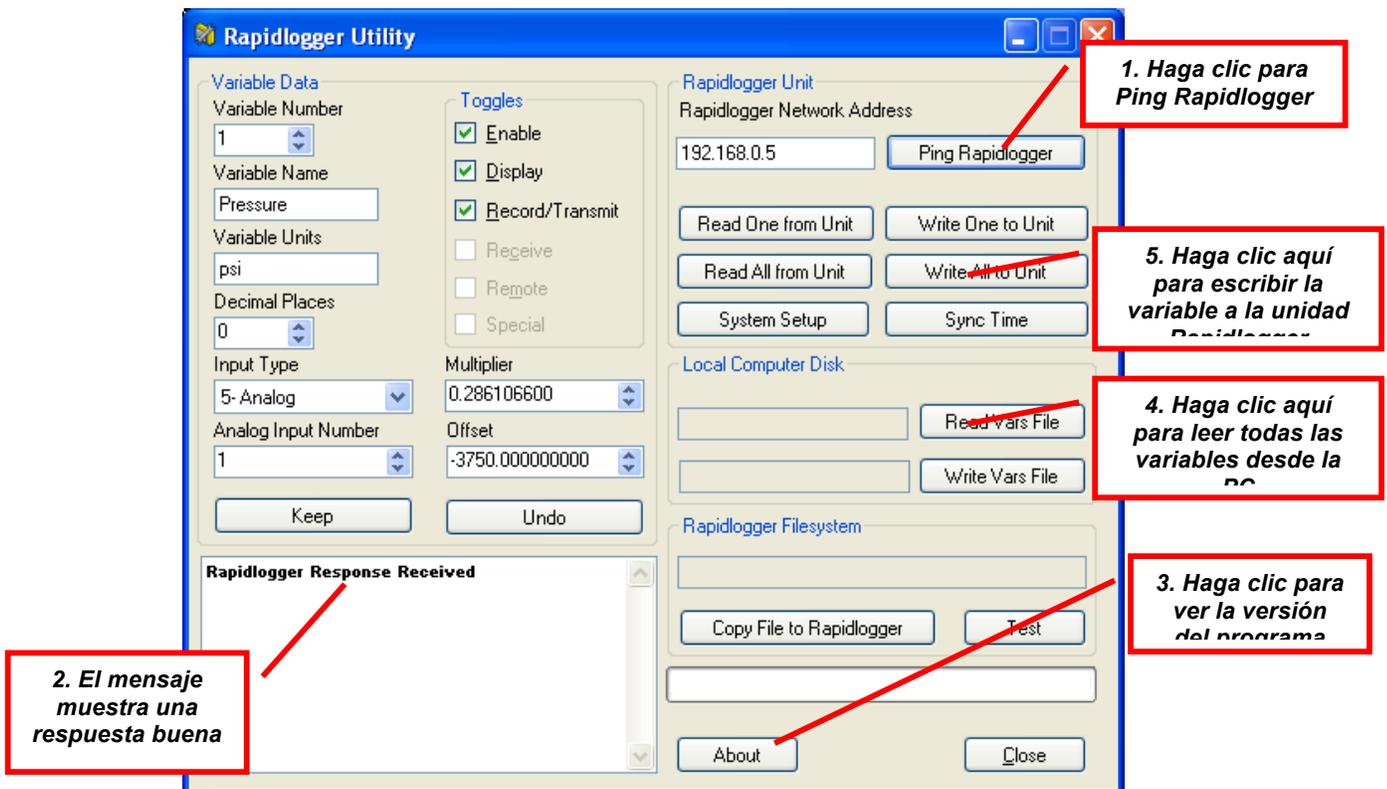
Figura 3 Usando el Rapidlogger Utility
