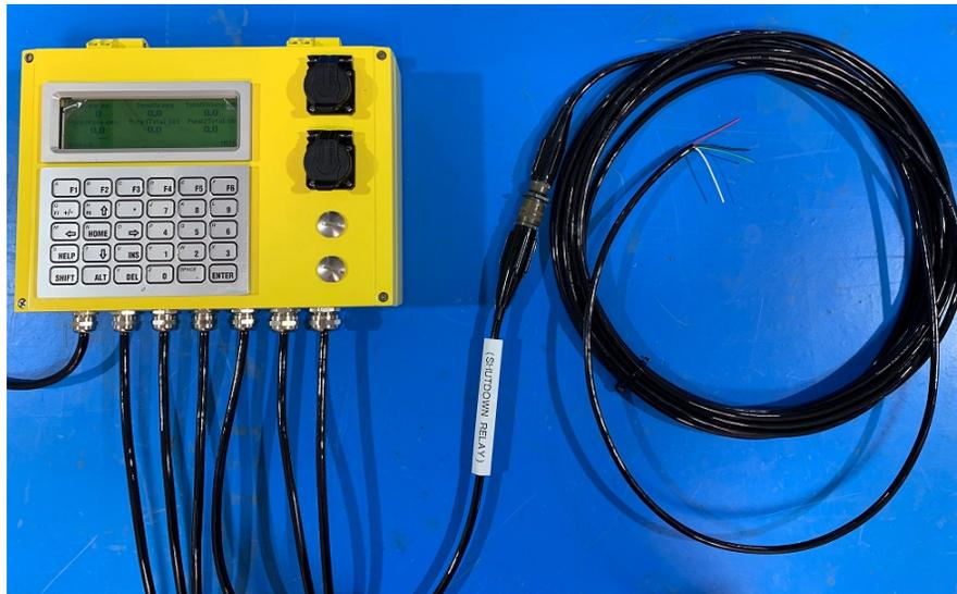
La imagen de arriba muestra el exterior del Rapidlogger con la conexión de apagado / cable auxiliar.
