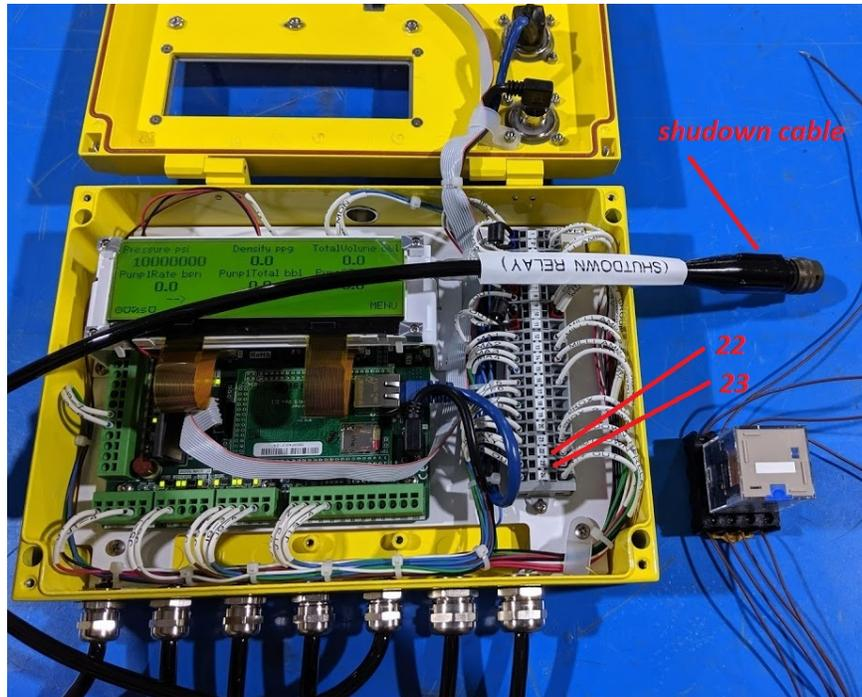
La imagen de arriba muestra el bloque de terminales interno del Rapidlogger. En un Rapidlogger estándar, los terminales 22, 23 son los terminales de salida de relé. Generalmente están conectados a un cable externo marcado como relé de apagado o sobrepresión, o cable auxiliar o cable de señal.
