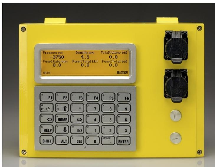
Figura 1 y 2: pantalla del medidor Coriolis Micro-Motion y unidad Rapidlogger.
